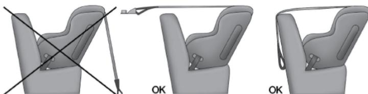
1. Observe detrás del asiento donde se planea instalar la protección de niño, para localizar los anclajes de correa. Tal vez sea necesario mover el asiento hacia delante para tener un mejor acceso a los anclajes. Si no se cuenta con anclajes superiores de correa para el asiento en esa posición (vea la imagen anterior), mueva la protección para niño a otra posición disponible en el vehículo.
