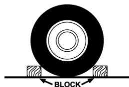
6. Bloquee la parte delantera y trasera de la rueda diagonalmente opuesta a la posición del gato. Por ejemplo, si se va a cambiar la rueda delantera derecha, bloquee la rueda trasera izquierda.
