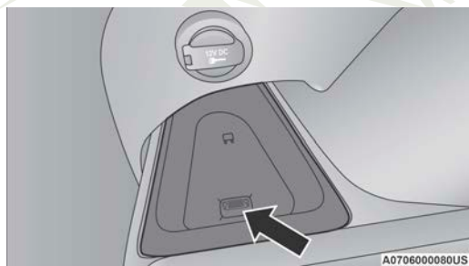
Acceso al panel de fusibles en el área de carga trasera
