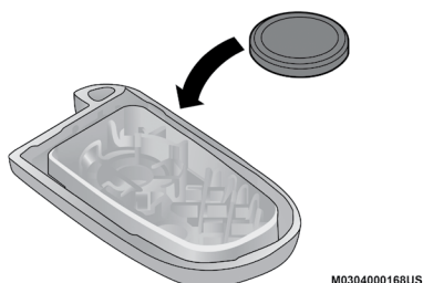
Reemplazo de la batería
