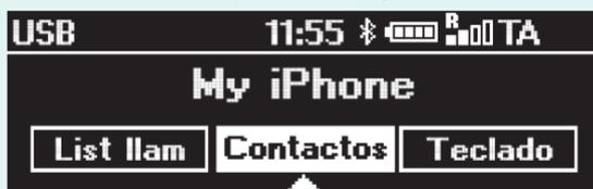
El sonido del teléfono móvil se transmite a través del sistema de audio del vehículo: el sistema desactiva automáticamente el sonido de la autorradio cuando se utiliza la función Teléfono.
