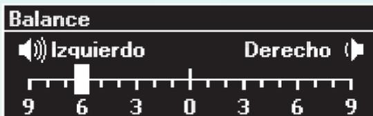
Seleccionar la opción “Fader” en la pantalla. Mediante el botón/selector BROWSE ENTER regular el balance de las bocinas delanteras/traseras. Una vez terminadas las regulaciones pulsar el botón “Back”.
