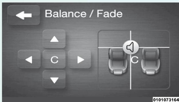
Presione la tecla en pantalla “Balance/Fade” (balance/desvanecimiento), para ajustar el sonido de las bocinas. Utilice la fecha digital para ajustar el nivel de sonido desde el frente y la parte trasera o las bocinas laterales derecha o izquierda. Toque la tecla en pantalla del centro “C” para reajustar el balance y desvanecimiento a la configuración de fábrica. Presione la flecha “back” (regresar) cuando termine.
