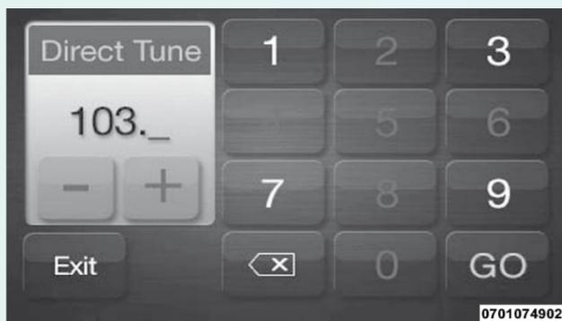
La pantalla de sintonización directa está disponible en AM, FM y SXM – Si está equipado los modos de radio se puede usar para sintonizar directamente el radio a una estación o a un canal deseado. Presione el botón “Tune” (Sintonizar), ubicado en la parte inferior de la pantalla táctil de la radio.
