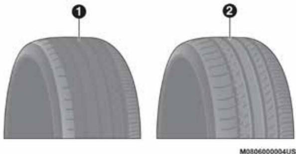
Desgaste o dibujo de llanta
