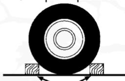
6. Bloquee la parte anterior y posterior de la rueda cuya posición sea diagonalmente opuesta a la de la rueda que levantará con el gato. Por ejemplo, si está cambiando la llanta delantera derecha, bloquee la rueda trasera izquierda.
