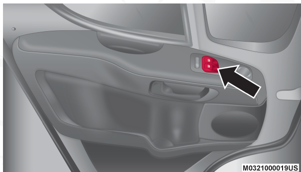
Interruptores de las ventanas eléctricas
