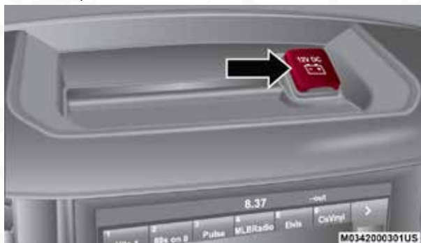
Toma de corriente – Arriba del panel
