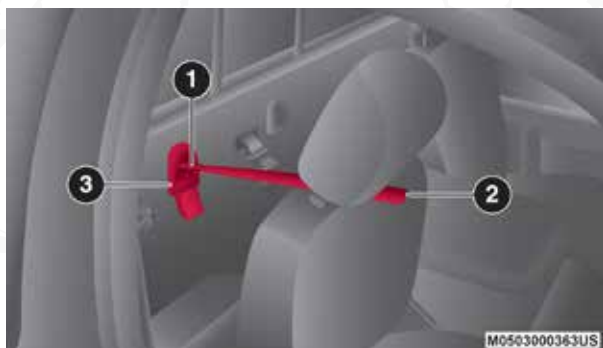
Anclajes de correa superiores en cabina regular (detrás de la cubierta)
