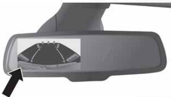
Espejo de regulación automática con pantalla de cámara trasera
