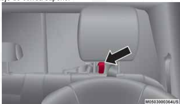
Anclaje de correa superior en Crew Cab
