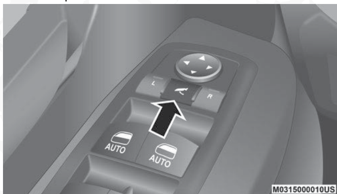
Interruptor de espejos eléctricos
