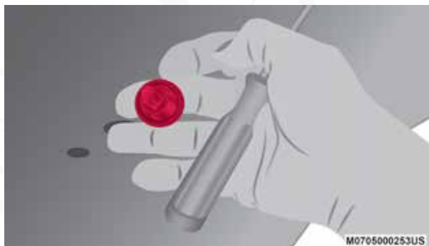
Retirando el foco del portafoco
