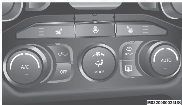
Perillas de control con Uconnect 4C/4C NAV del control de temperatura automático
