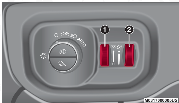
Control de atenuación
