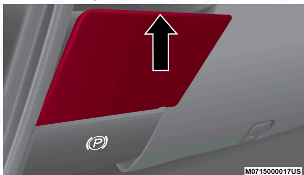
Cubierta de acceso para liberación manual de la posición de estacionamiento
