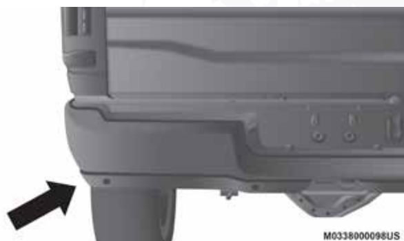
Ubicación del escalón de acceso
