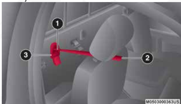
Anclaje superior en cabina regular
