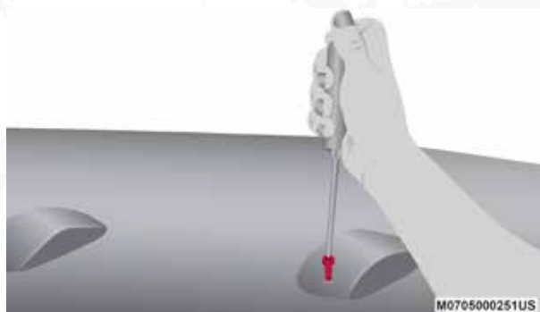
Retirando el tornillo de montaje de la lámpara
