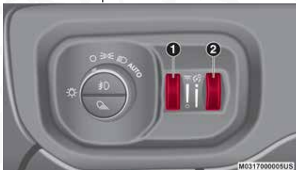
Control de atenuación
