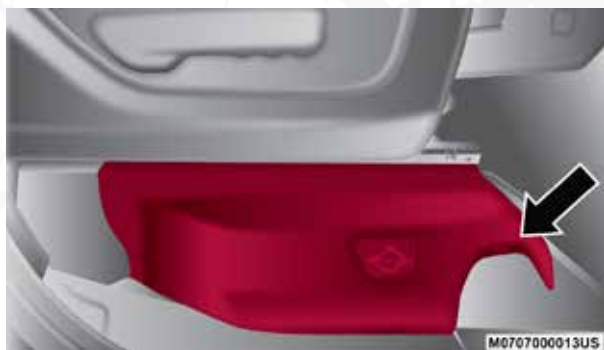
Cubierta de acceso al gato
