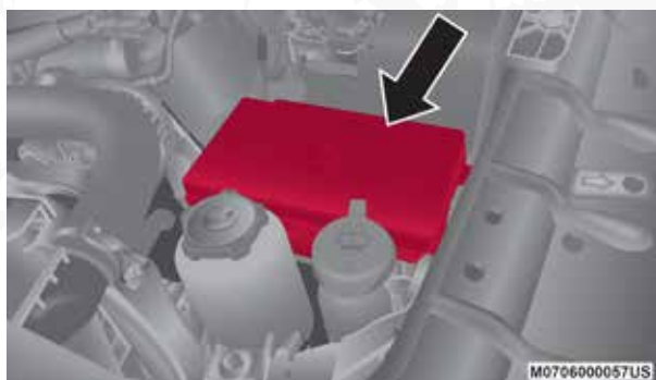
Localización del centro de distribución de energía
