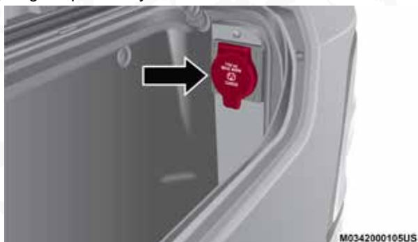
Inversor de corriente de la Ram Box
