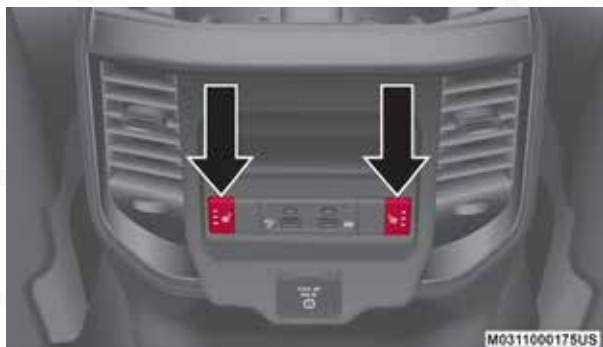
Interruptores de los asientos traseros con calefacción
