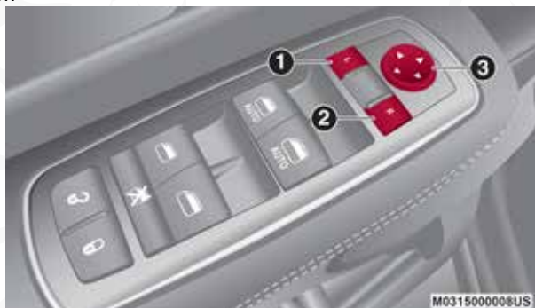
Interruptor del espejo eléctrico
