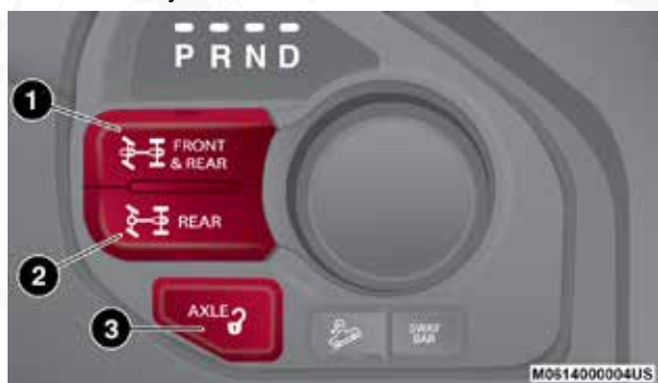
Selector de bloqueo de eje
