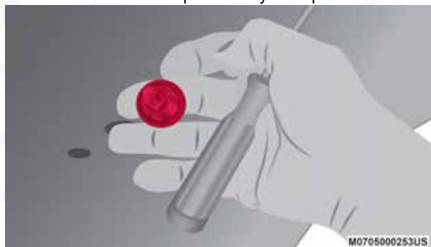
Retirando el foco del portafoco
