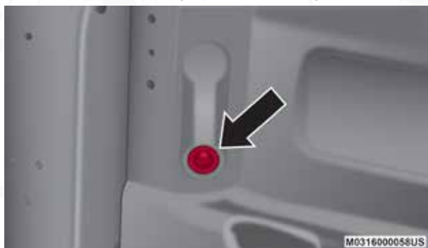
Interruptor de la luz de batea sin RamBox
