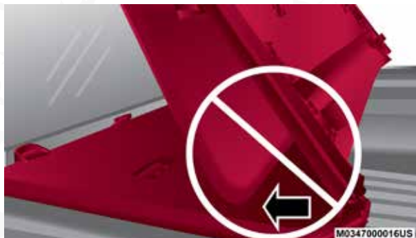
Doblado incorrecto - Causará daño
