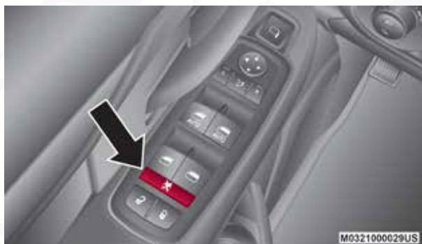
Interruptor de bloqueo de las ventanas
