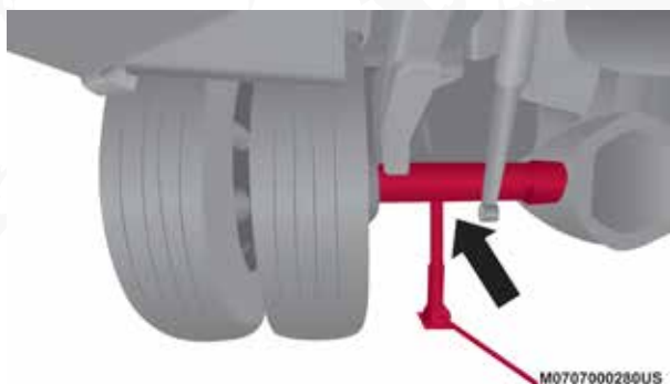
Colocación del gato con la rueda trasera doble
