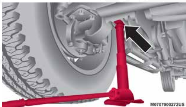
Colocación del gato en la parte delantera
