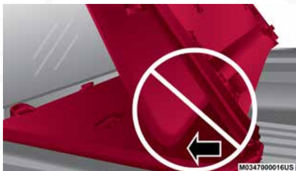
Doblado incorrecto - Causará daño
