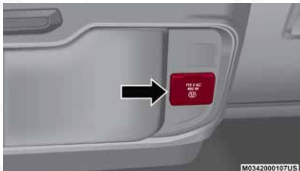
Inversor de corriente de la Ram Box
