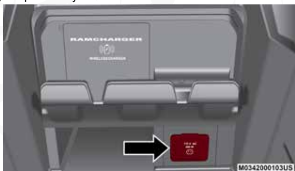
Toma de inversor de energía
