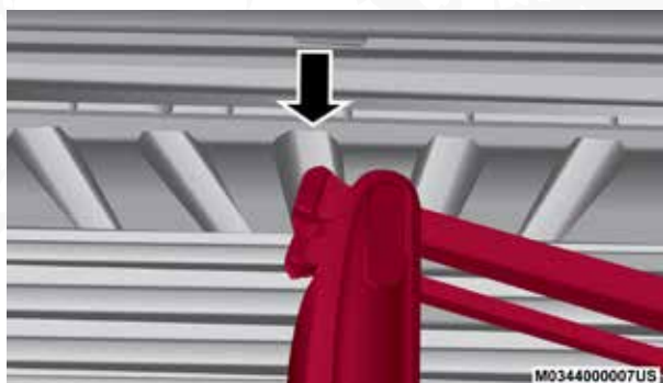
Alineación de la compuerta hacia las ranuras
