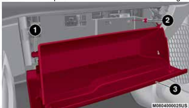
Instalación de la guantera
