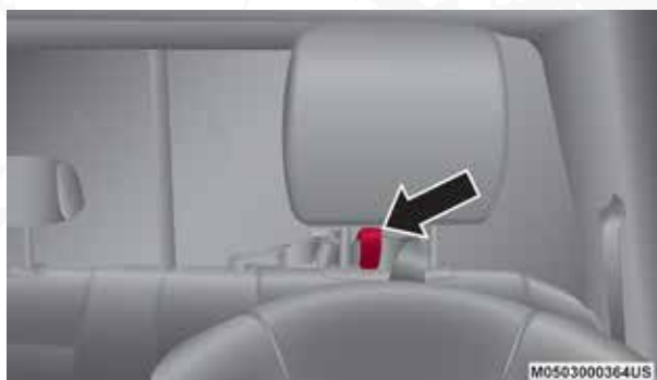
Anclaje de correa superior en Crew Cab
