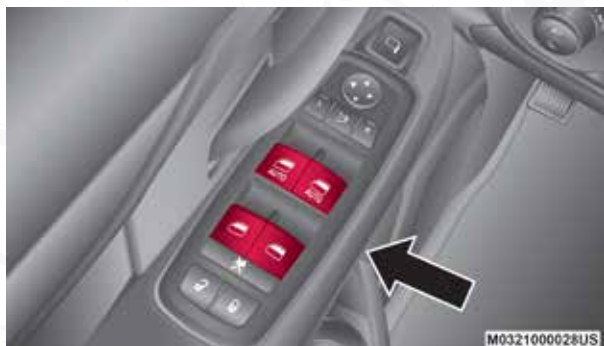
Interruptores de las ventanas eléctricas
