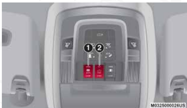
Interruptores del quemacocos
