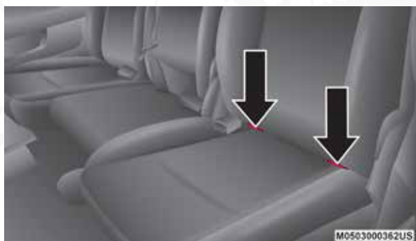
Anclajes LATCH Crew Cab®
