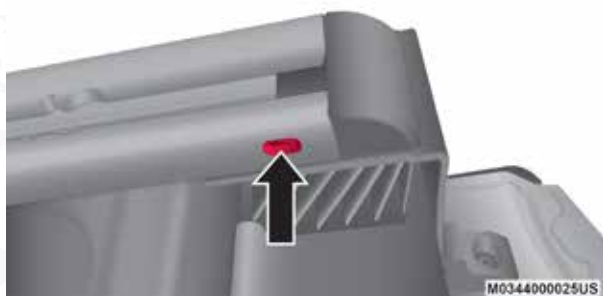
Botón de liberación de la tapa del extremo del riel si no está equipado con cubierta
