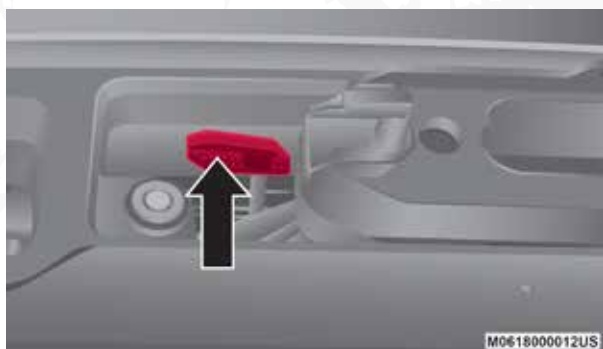
Palanca de liberación de carrete del malacate
