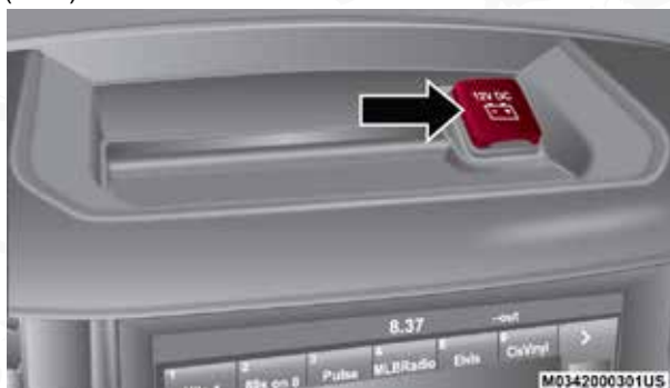
Toma de corriente – Panel central
