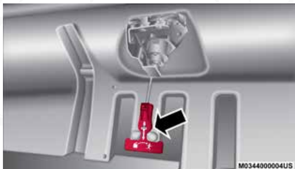
Palanca de liberación de emergencia
