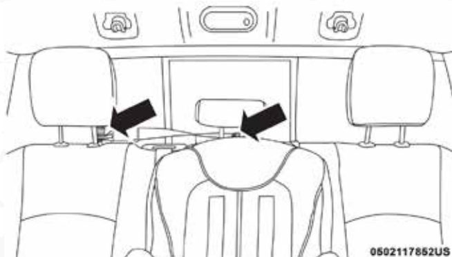
Correa de sujeción a través del aro de sujeción central y asegurado del aro de la correa lateral
