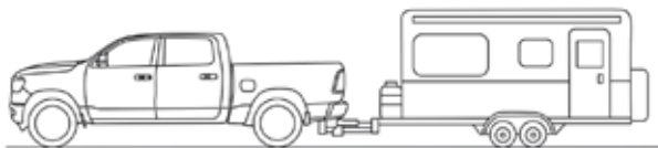
EJEMPLO — Con enganche de distribución del peso (correcto)
