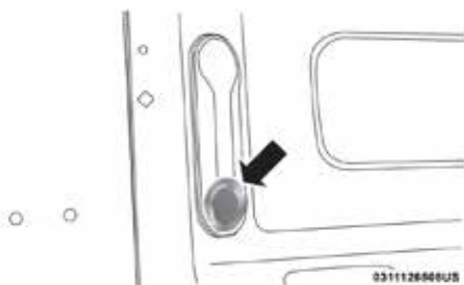
Interruptor de las luces dentro de la batea
