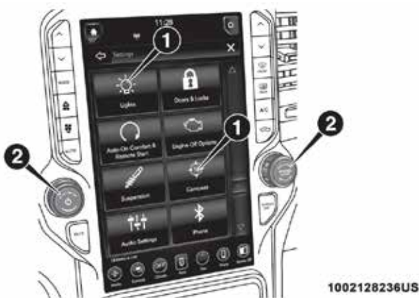
Botones en el tablero y botones en la pantalla del radio Uconnect/4C NAV 12”
