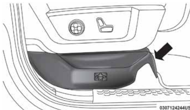
Cubierta de acceso al gato
