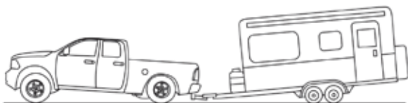
EJEMPLO — Sin enganche de distribución del peso (incorrecto)
