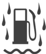
O APARECE EL MENSAJE "WATER IN FUEL", INDICA QUE SE HA DETECTADO AGUA EN EL COMBUSTIBLE POR LO QUE USTED DEBE PROCEDER A DRENAR EL FILTRO SEPARADOR DE COMBUSTIBLE/AGUA, CONSULTE LA SECCIÓN DE MANTENIMIENTO EN ESTE MANUAL.
