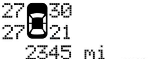
Pantalla del monitoreo de llanta con presión baja
