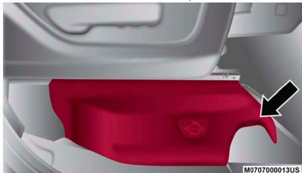
Cubierta de acceso al gato
