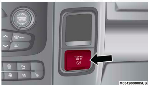
Toma de inversor de energía
