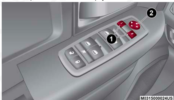
Interruptores de espejos eléctricos
