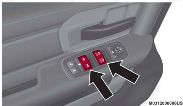
Interruptores de las ventanas eléctricas
