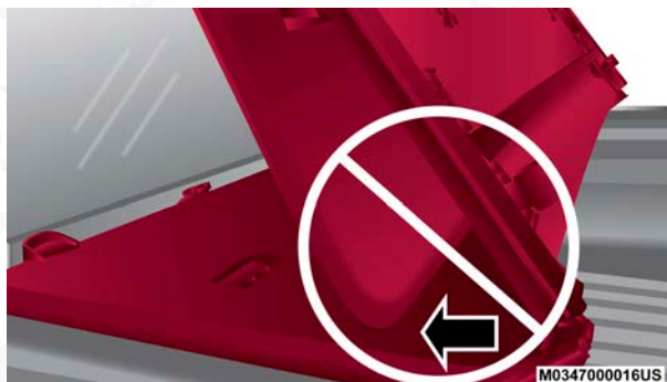
Doblado incorrecto - Causará daño
