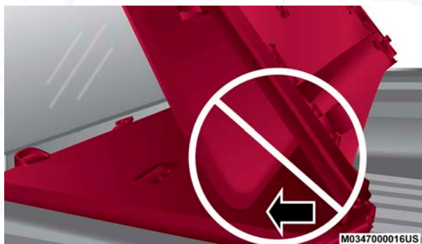
Doblado incorrecto - Causará daño
