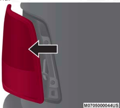
Extracción de las luces traseras
