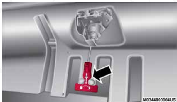
Palanca de liberación de emergencia
