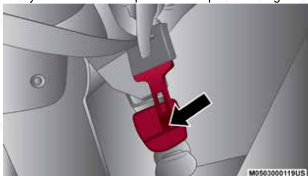
Desprendimiento de la hebillas con la lengua del cinturón de seguridad
