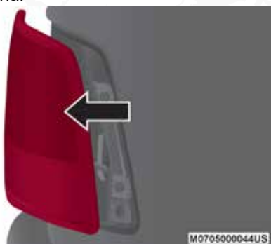
Extracción de las luces traseras
