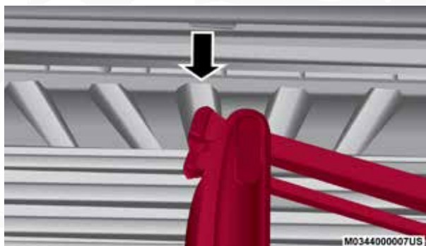
Alineación de la compuerta hacia las ranuras
