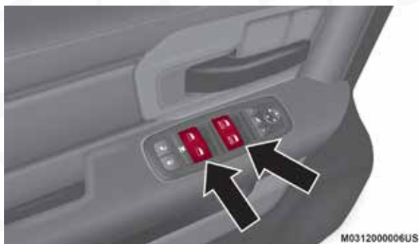
Interruptores de las ventanas eléctricas
