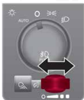
Control de atenuación
