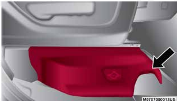
Cubierta de acceso al gato
