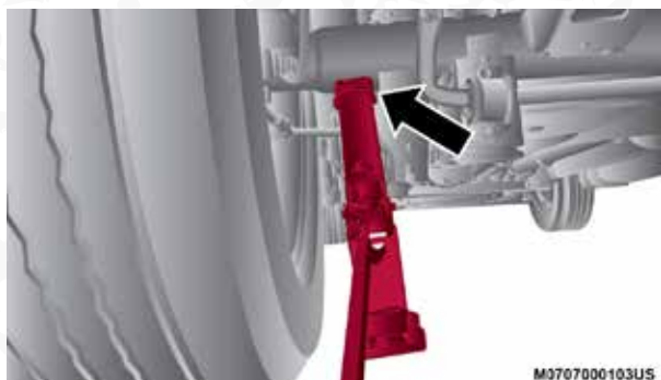
Colocación del gato en la parte trasera
