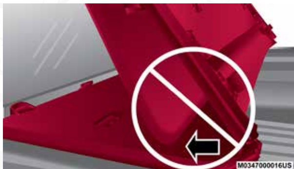
Doblado incorrecto - Causará daño
