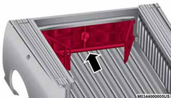
Posición de almacenamiento
