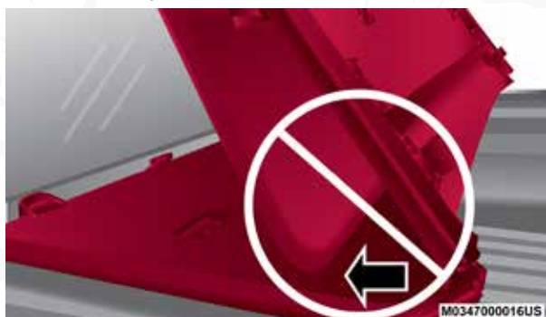
Doblado incorrecto - Causará daño
