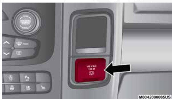
Toma de inversor de energía
