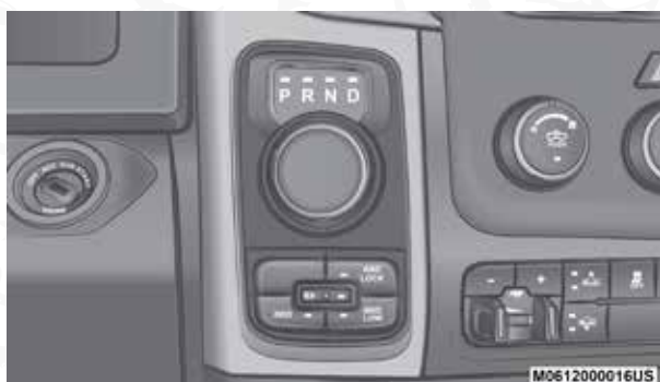
Interruptor de la caja de transferencia (con transmisión de 8 velocidades)
