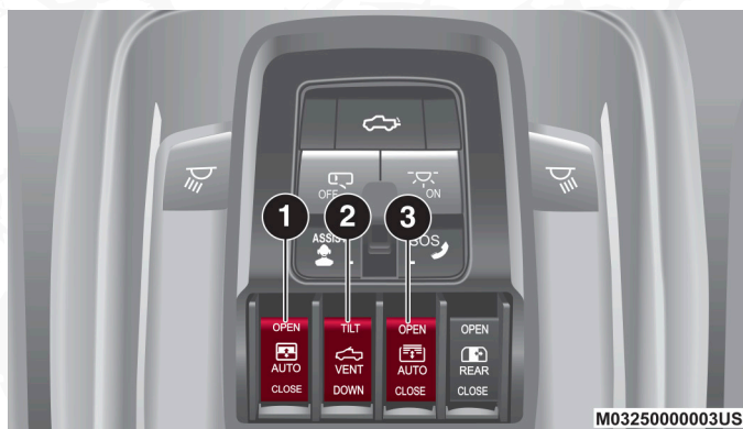
Interruptor del toldo solar
