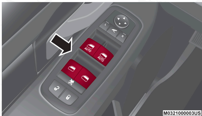
Interruptores de las ventanas eléctricas
