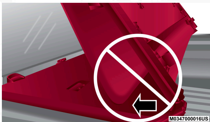
Doblado incorrecto - Causará daño
