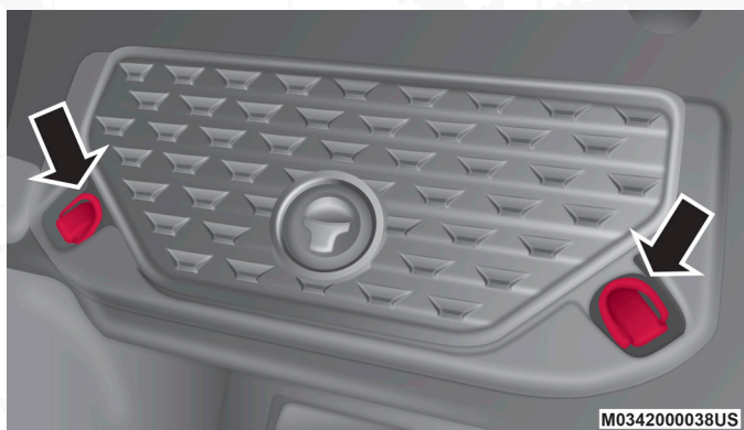
Ganchos del compartimiento de almacenamiento
