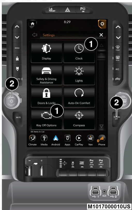
Botones en el tablero y botones en la pantalla del radio Uconnect/4C NAV 12"
