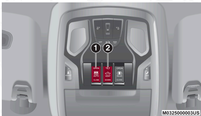
Interruptor del toldo solar
