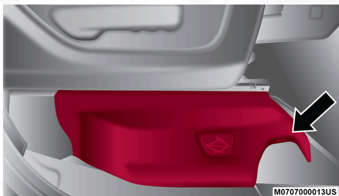
Cubierta de acceso al gato
