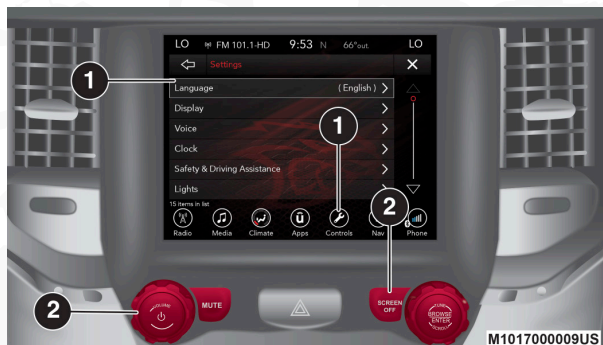
Botones en el tablero y botones en la pantalla del radio Uconnect 4/4C/4C NAV 8.4"
