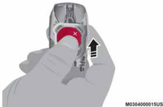
Reemplazo de la batería
