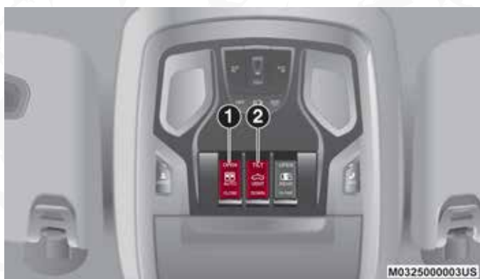
Interruptor del toldo solar
