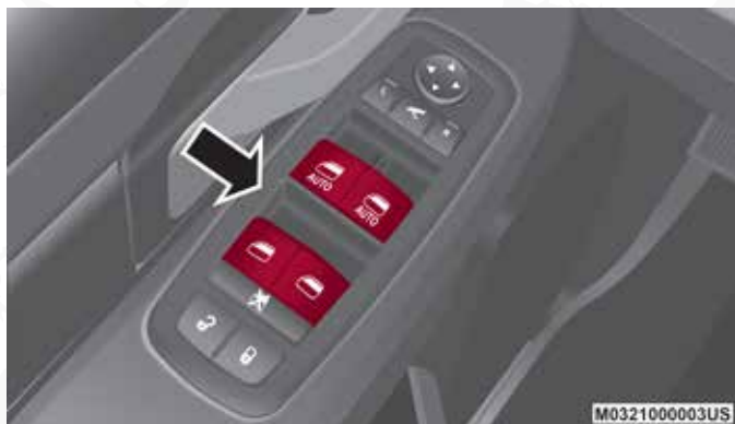
Interruptores de las ventanas eléctricas
