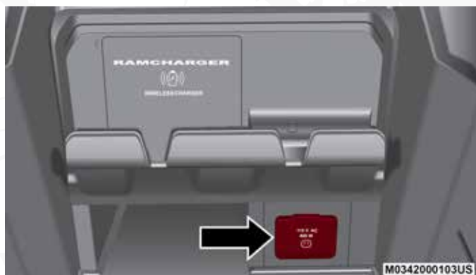
Toma de inversor de corriente de la consola central
