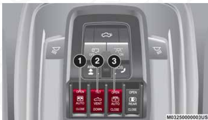
Interruptor del toldo solar
