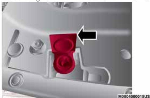
Abriendo el depósito de refrigerante
