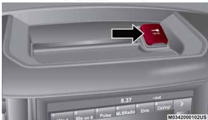
Toma de corriente – Arriba del panel
