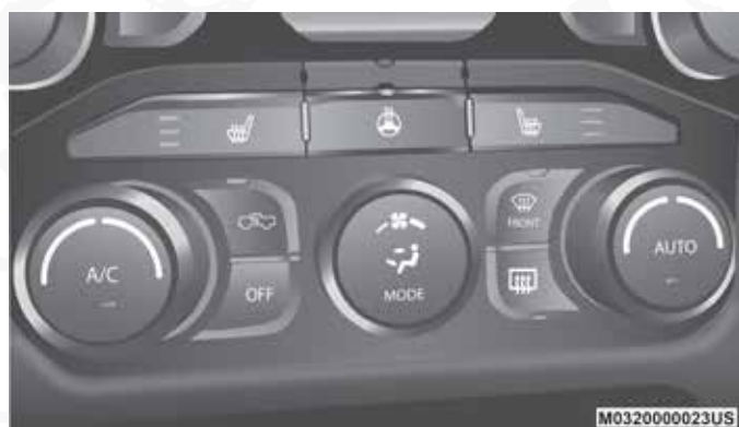
Perillas de control automático de clima en Uconnect 4C/4C Nav con pantalla de 8.4"
