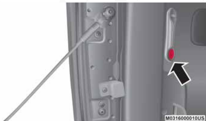
Interruptor de las luces dentro de la batea
