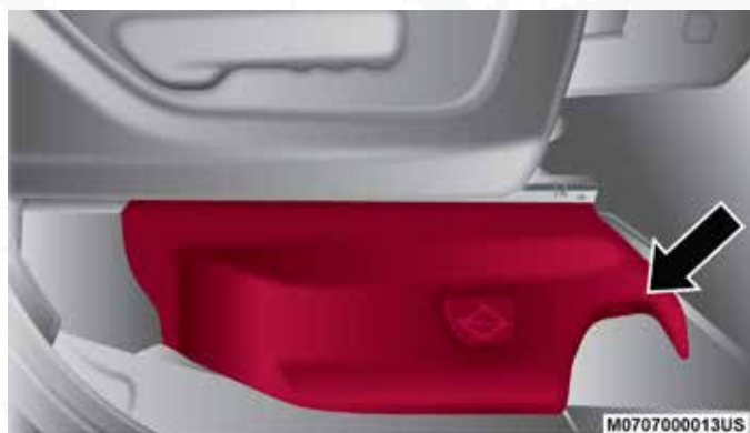
Cubierta de acceso al gato
