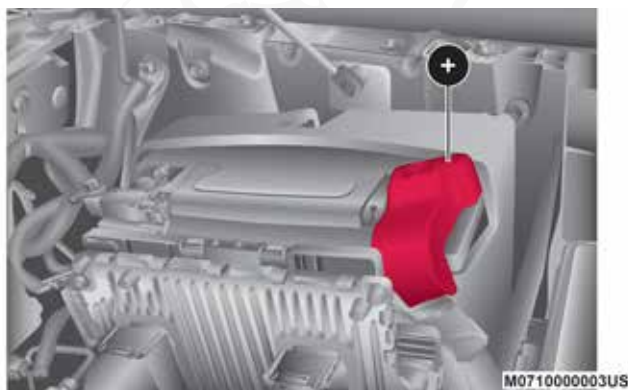
Terminal positiva en la batería
