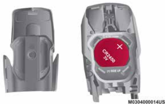
Ubicación de la batería del control
