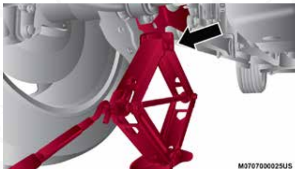
Colocación del gato en la parte trasera
