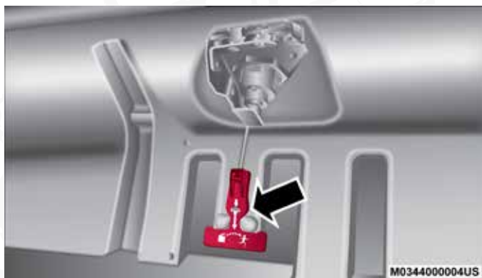
Palanca de liberación de emergencia
