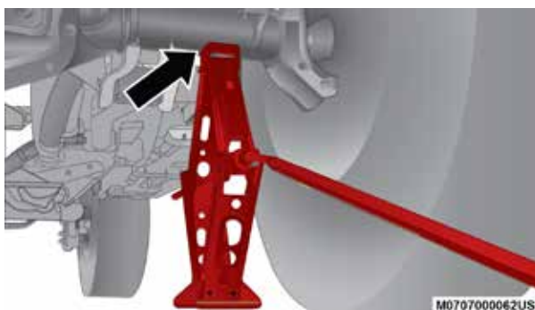
Colocación del gato en la parte delantera
