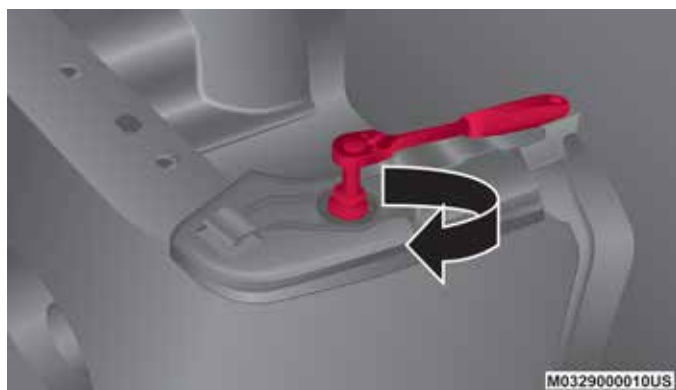
Instalación de los retenedores traseros
