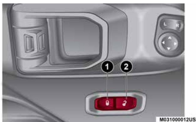
Seguro eléctrico de la puerta
