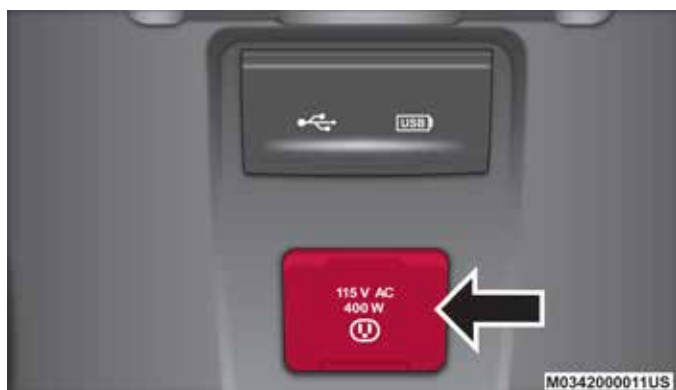
Inversor de corriente
