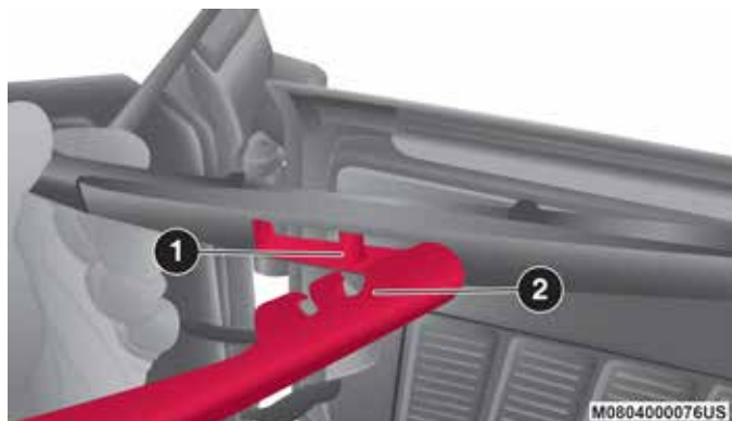
Hoja limpiadora retirada del brazo limpiador
