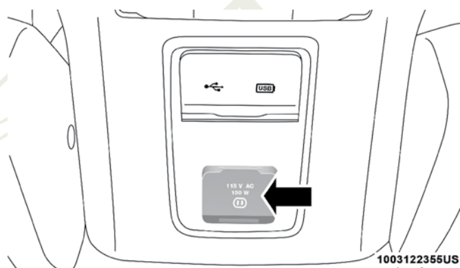
Inversor de corriente
