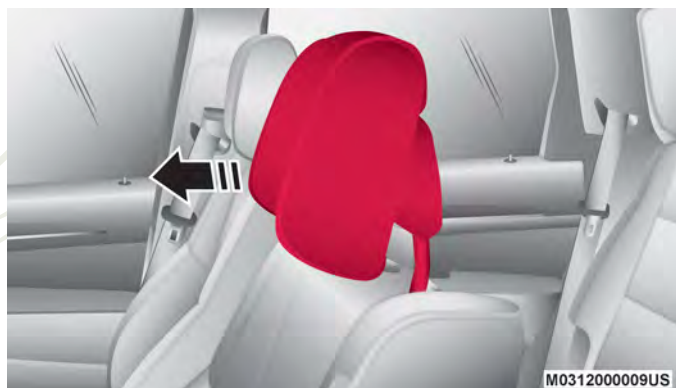
Cabecera activa (inclinada)
