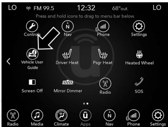
Ícono de Guía del usuario en Uconnect 4C NAV con pantalla de 8.4 pulgadas
