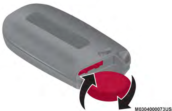
Separación de la cubierta usando una moneda
