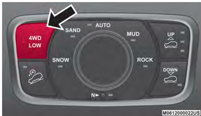
Interruptor de la caja de transferencia
