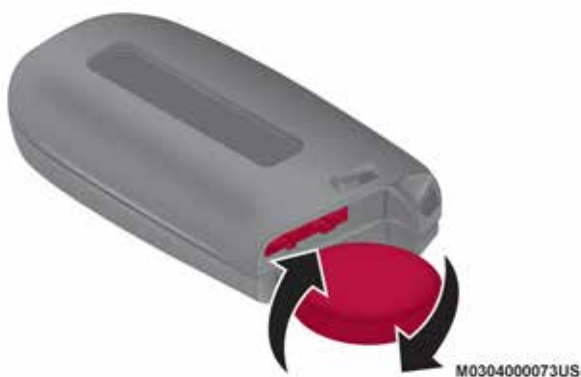
Separación de la cubierta usando una moneda
