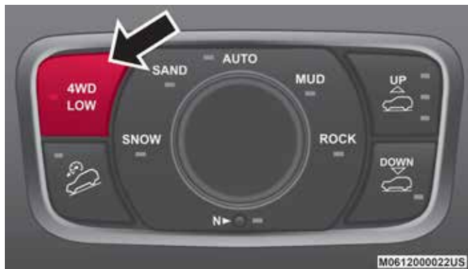
Interruptor de la caja de transferencia
