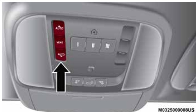
Interruptores del quemacocos
