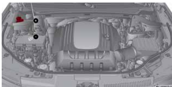
Ubicación de postes remotos bajo el cofre
