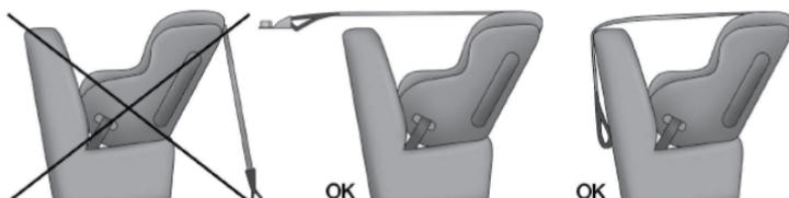
1. Observe detrás de la posición del asiento donde se planea instalar la protección de niño para localizar los anclajes de correa. Tal vez sea necesario mover el asiento hacia adelante para tener un mejor acceso a los anclajes. Si no se cuenta con anclajes superiores de correa para el asiento en esa posición (vea la imagen anterior), mueva la protección para niño a otra posición disponible en el vehículo.
