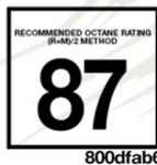
El motor está diseñado para cumplir con todos los reglamentos de emisiones y para proveer un excelente desempeño y rendimiento de combustible, con el uso de gasolina Magna (sin plomo y de alta calidad). El de gasolina Premium no aporta beneficio alguno sobre la gasolina Magna en estos motores.
