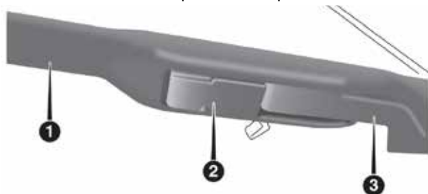
Pluma del limpiador con la pestaña en posición de bloqueo
