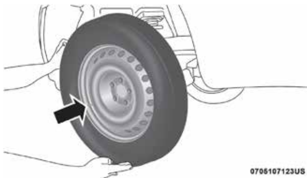
Montado de la llanta de repuesto
