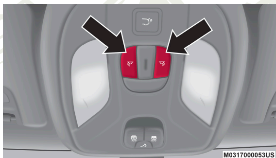
Interruptores de luces de consola superior
