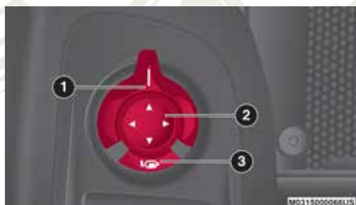
Interruptor del espejo eléctrico
