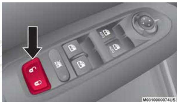
Interruptor de los seguros eléctricos de las puertas
