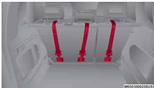
Anclaje de la correa superior
