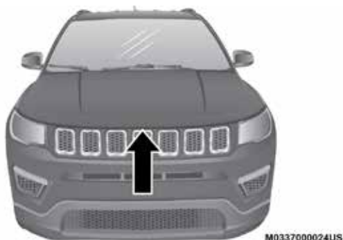
Localización del pestillo de seguridad
