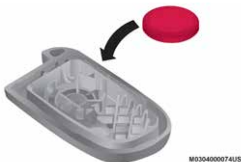
Reemplazo de la batería
