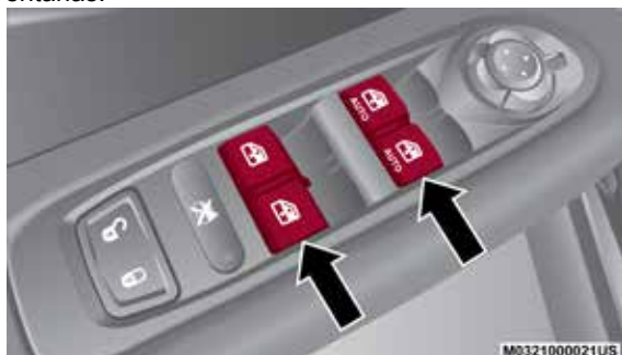
Interruptores de las ventanas eléctricas
