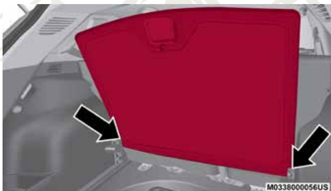
Piso del área de carga totalmente levantado
