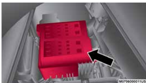
Cubierta de la cavidad trasera de los fusibles del área de carga
