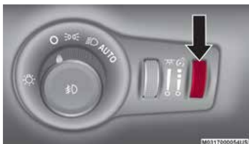
Control de atenuación
