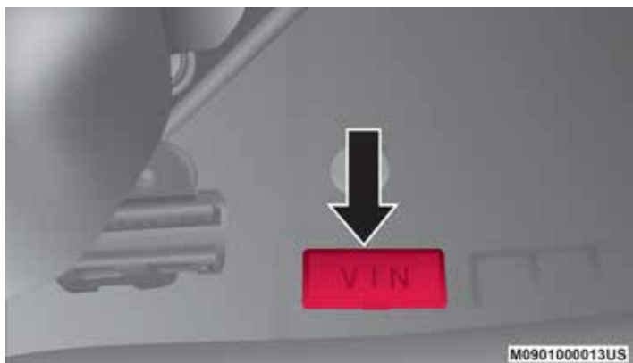
Ubicación en piso del número de identificación vehicular (VIN)
