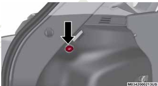
Toma de corriente del área de carga
