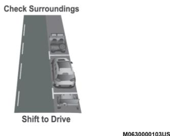
Cuando el conductor coloque el selector en la posición de conducir, el sistema puede indicarle esperar a que el movimiento del volante termine.
