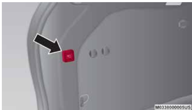
Manija de cerrado de la compuerta levadiza
