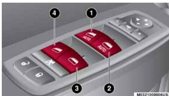
Interruptores de las ventanas eléctricas
