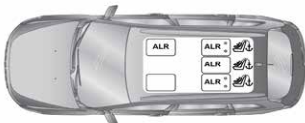
Ubicación del retractor de bloqueo automático en asientos de posición fija
