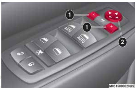
Interruptores de los espejos eléctricos
