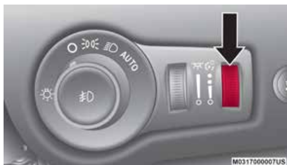
Control de atenuación
