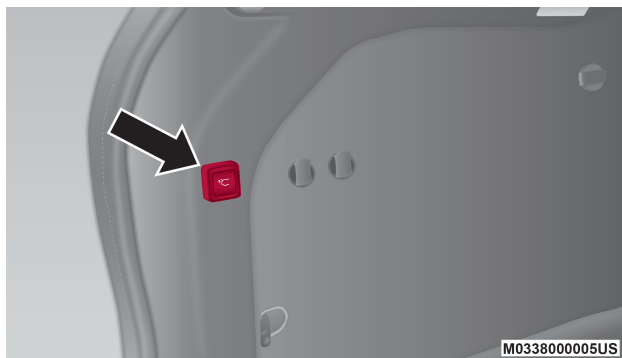
Manija de cerrado de la compuerta levadiza
