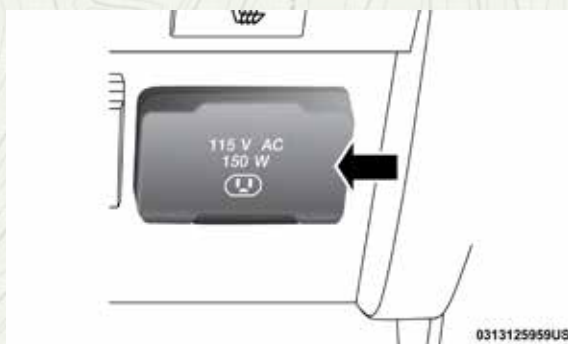
Inversor de corriente localizado en la parte trasera de la consola central
