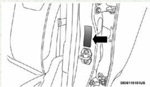
Ejemplo de etiqueta de presión de inflado (pilar B)
