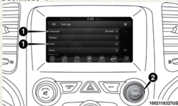
Botones en pantalla y tablero del sistema Uconnect 4 con pantalla de 7"
