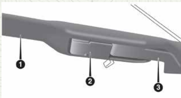
Pluma del limpiador con la pestaña en posición de bloqueo
