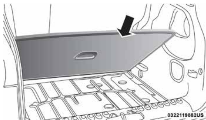
Característica de inclinación del piso de carga
