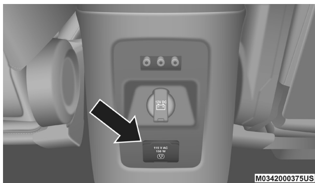
Inversor de corriente
