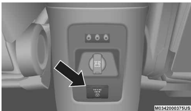
Inversor de corriente
