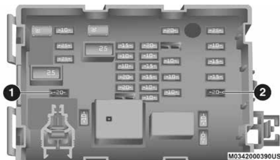
Fusibles de las tomas de corriente
