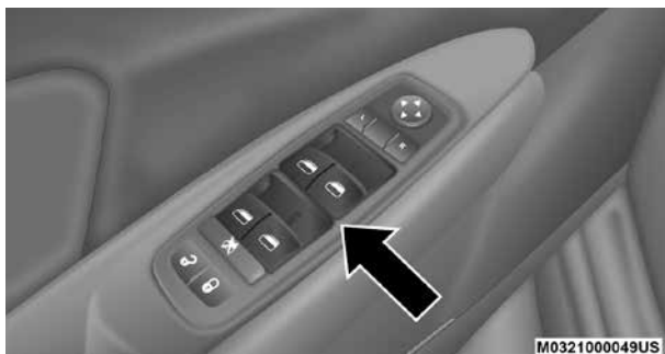
Interruptores de las ventanas eléctricas
