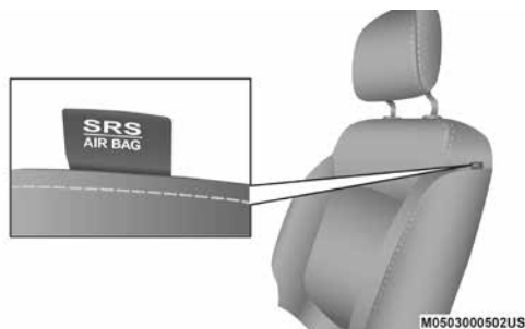
Etiqueta de la bolsa lateral (SAB) montada en el asiento
