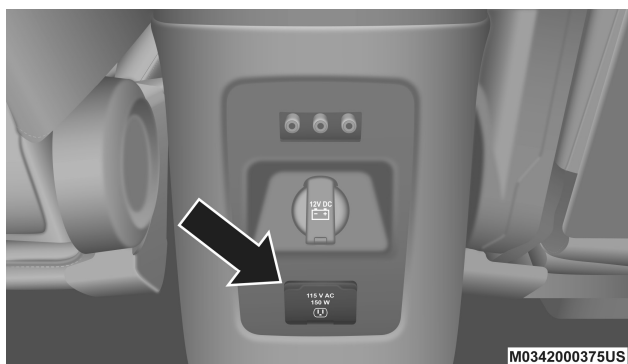
Inversor de corriente
