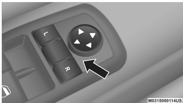
Interruptores de espejos eléctricos
