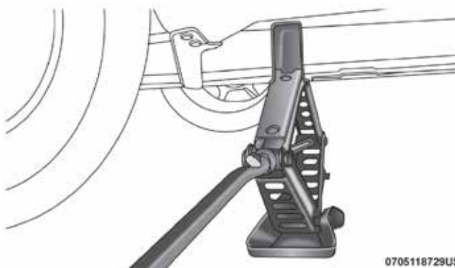
Colocación del gato parte trasera
