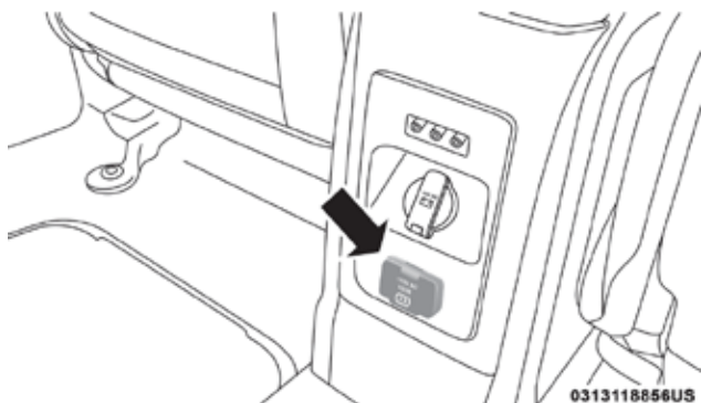
Inversor de corriente
