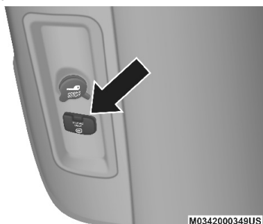
Inversor de corriente
