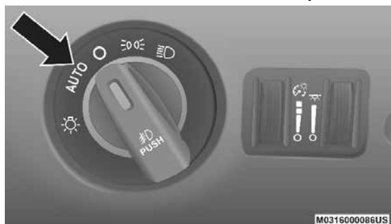
Interruptor de las luces
