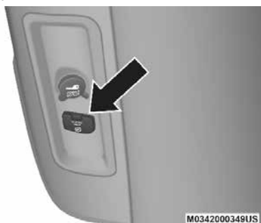
Inversor de corriente
