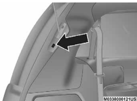
Botón de la compuerta levadiza eléctrica
