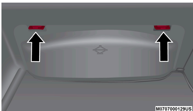
Lengüetas de la cubierta de almacenamiento
