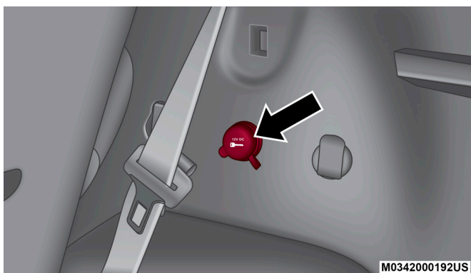
Toma de corriente del área de carga
