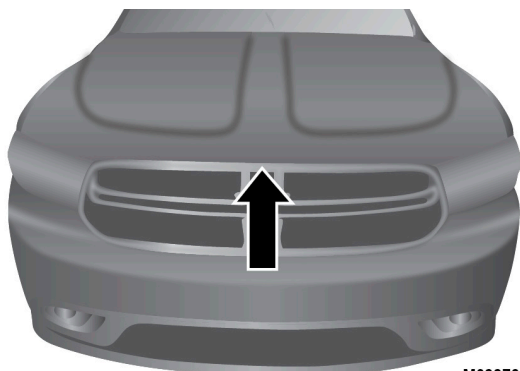
Localización de anclaje de seguridad
