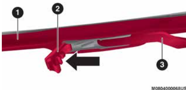
Pluma del limpiador con la pestaña en posición de liberación
