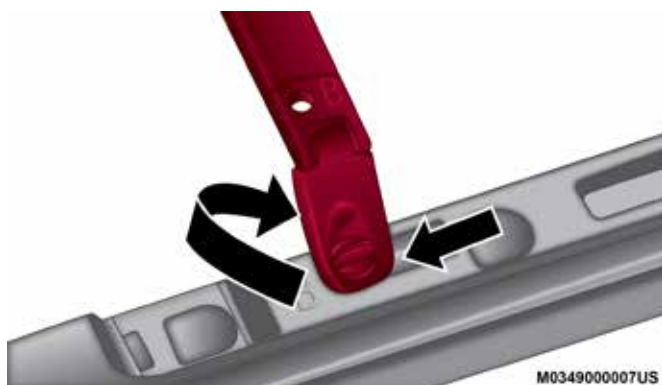
Instalación de las barras laterales
