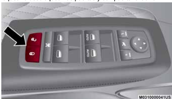
Interruptores de los seguros eléctricos de las puertas
