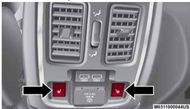
Interruptores de asientos con calefacción
