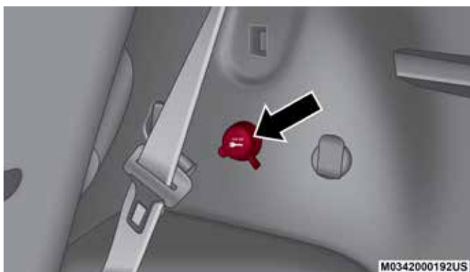
Toma de corriente del área de carga
