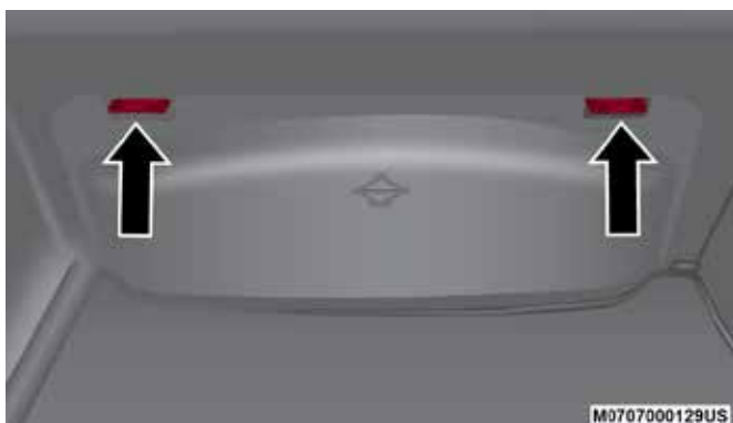
Lengüetas de la cubierta de almacenamiento
