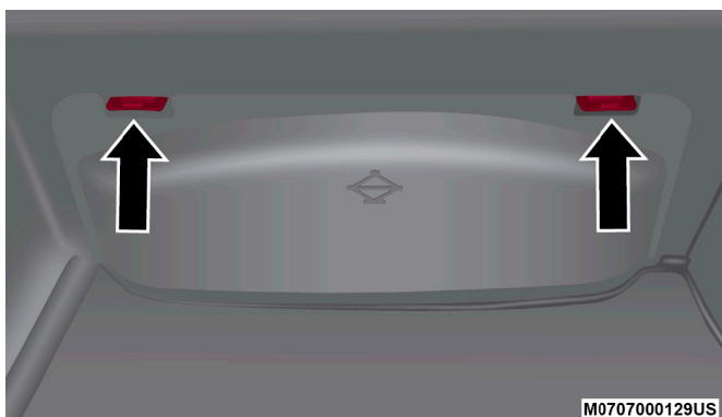
Lengüetas de la cubierta de almacenamiento
