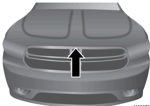
Localización de anclaje de seguridad
