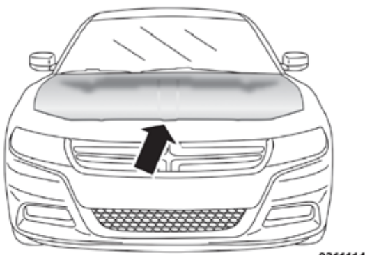
Localización de la traba de seguridad para liberar el cofre
