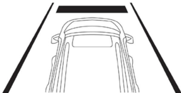
Configuración de distancia 1 (corta)
