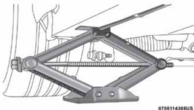
Colocación del gato en la parte frontal
