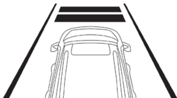
Configuración de distancia 2 barras (media)
