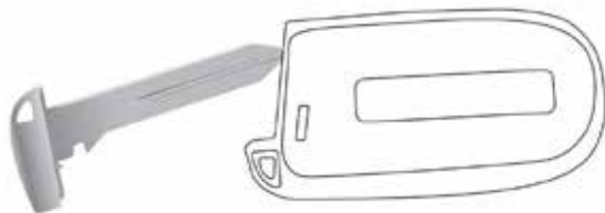
Retiro de llave de emergencia
