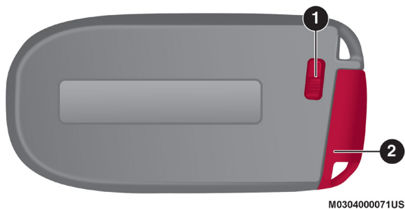
Retiro de llave de emergencia
