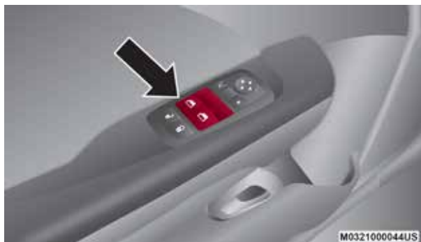
Interruptores de las ventanas eléctricas
