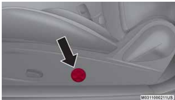
Control del soporte lumbar eléctrico
