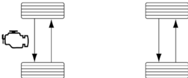
Rotación de llantas (lado a lado)
