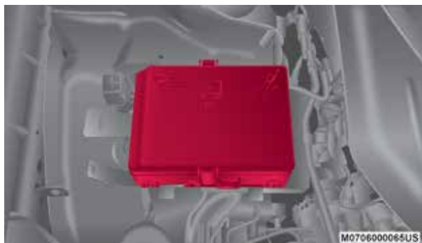
Centro de distribución frontal de energía
