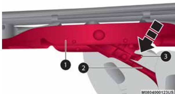
Hoja del limpiador con la pestaña de liberación en posición de desbloqueo
