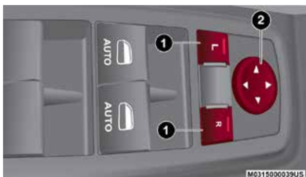
Interruptores de espejos eléctricos
