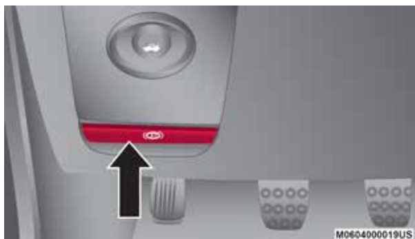
Liberador del freno de estacionamiento (transmisión manual)
