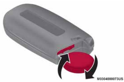
Separación de la cubierta usando una moneda
