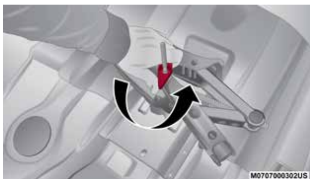
Afrojando el sujetador que asegura el gato
