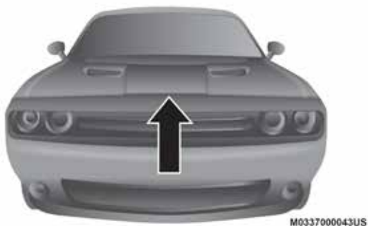
Localización de la traba de seguridad para liberar el cofre
