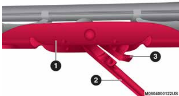
Hoja del limpiador con la pestaña de liberación en posición de bloqueo
