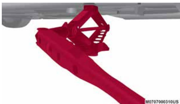
Colocación del gato en la parte trasera
