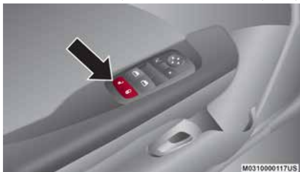
Localización de los interruptores de los seguros eléctricos
