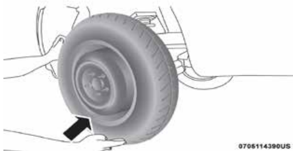
Montaje de la llanta de refacción
