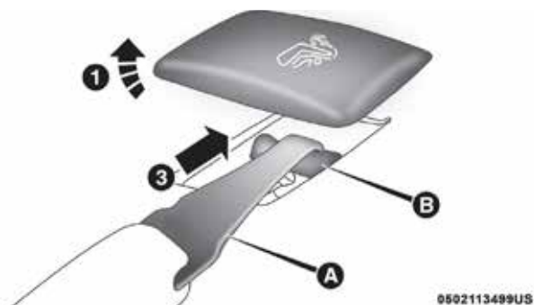
Montaje de la correa de sujeción
