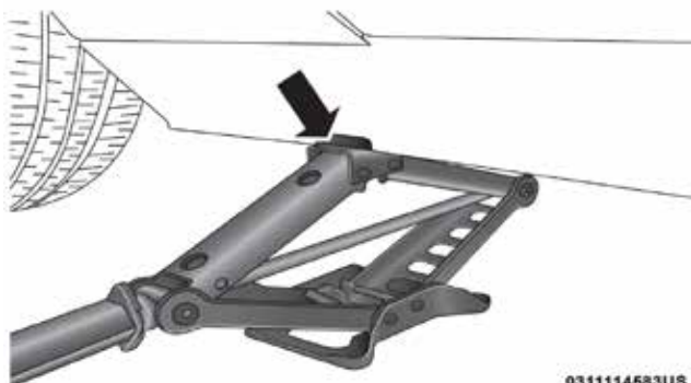
Colocación del gato en la parte frontal
