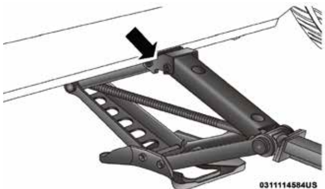
Colocación del gato en la parte trasera
