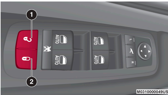
Seguros eléctricos de la puerta del conductor
