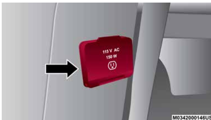
Inversor de corriente de 115 volts
