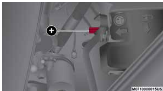
Polo positivo remoto de la batería
