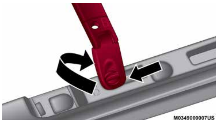
Instalación de las barras
