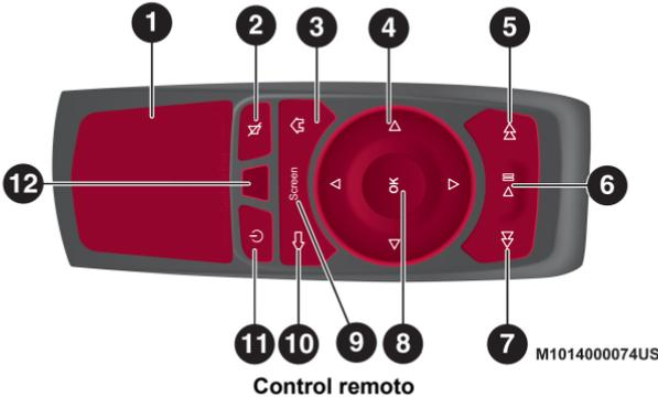
1. Superficie táctil - Controle la posición del puntero en esta área para mover y seleccionar objetos en la pantalla táctil, funciona de manera similar a un puntero/ratón de computadora portátil.
