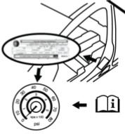
1. Presione el botón de encendido (4) para encender e inflar la llanta a la presión indicada en la etiqueta de información de llantas y carga localizada del lado de la puerta del conductor
