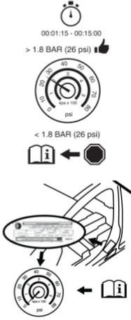
1. Continúe operando la bomba hasta que el sellador ya no esté fluyendo a través de la manguera (normalmente toma de 30 a 70 segundos). Como el sellador vaya fluyendo a través de la manguera, el indicador de presión bajará de aproximadamente 70 psi (4.8 bar) a la presión de la llanta cuando la botella de sellador este vacía.
