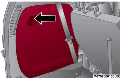
Localización del equipamiento de cambio de llanta
