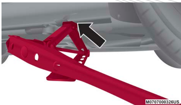
Colocación del gato en la parte trasera
