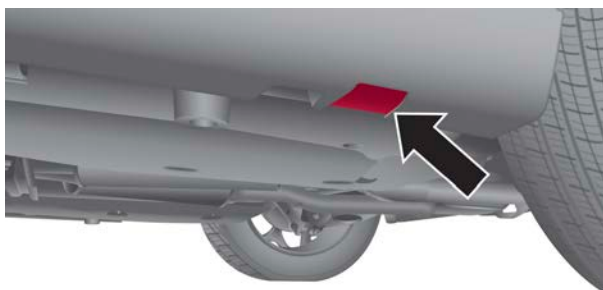
Colocación del gato en la parte frontal
