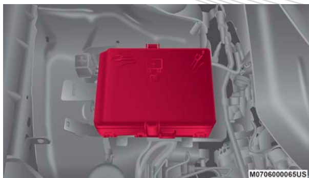
Centro de distribución frontal de energía
