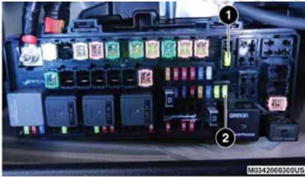
Localización de los fusibles de las tomas de corriente
