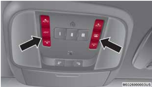
Interruptor del toldo solar eléctrico y cortinilla eléctrica
