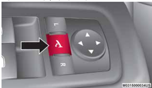
Interruptor de espejos eléctricos plegables eléctricamente
