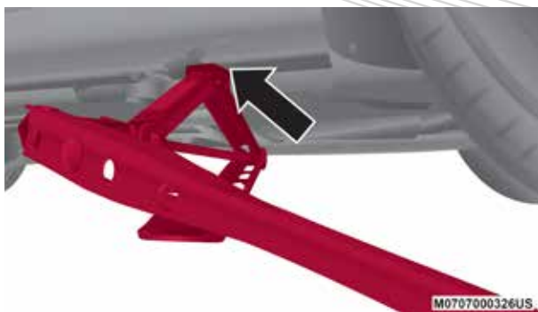
Colocación del gato en la parte trasera
