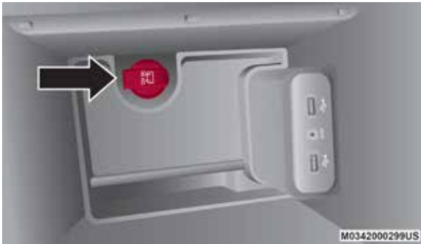
Toma de corriente de la consola central
