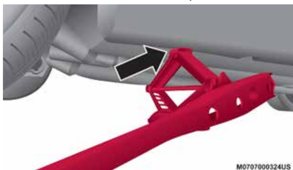
Colocación del gato en la parte frontal
