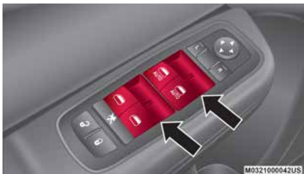
Interruptores de las ventanas eléctricas
