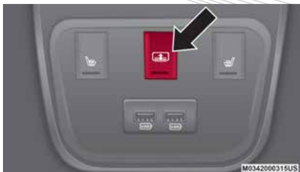
Interruptor de sombra eléctrica
