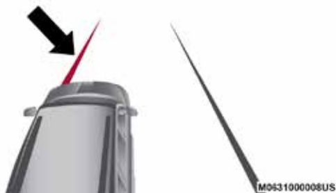
Aproximación de carril (línea gruesa destellando amarillo, la línea delgada es de color amarillo sólido/indicador destellando de color amarillo).
